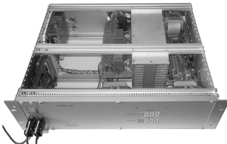
Рис. 3. Двухканальный источник подшунтирования SHUNT-20
