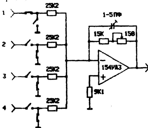
Рис. 3. Схема коммутирующего узла.
