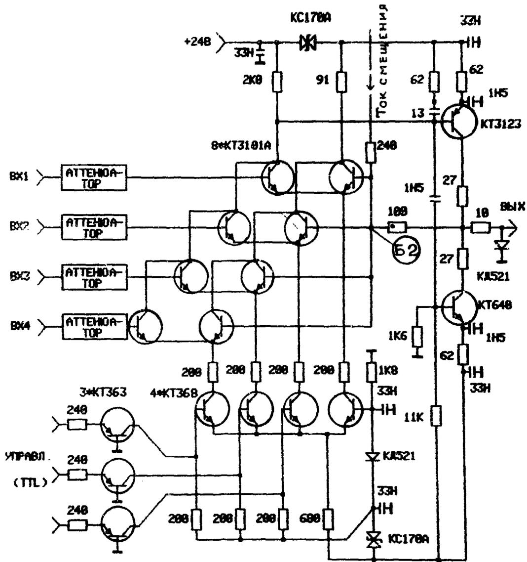
Рис. 10. Принципиальная схема коммутующего узла.
