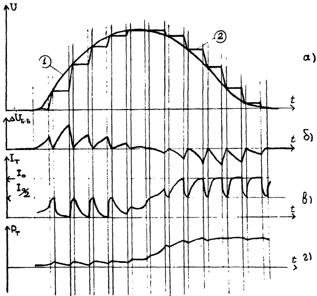
Рис. 8. Возникновение разбаланса мощностей в схеме УВХ: 1—напряжение на входе УВХ, 2—на выходе. На рис. 8,б показана разность напряжений между левой и правой базой (перекос дифференциальной пары);  $v$ —ток в левом по схеме транзисторе;  $z$ —рассеиваемая на этом транзисторе мощность.
