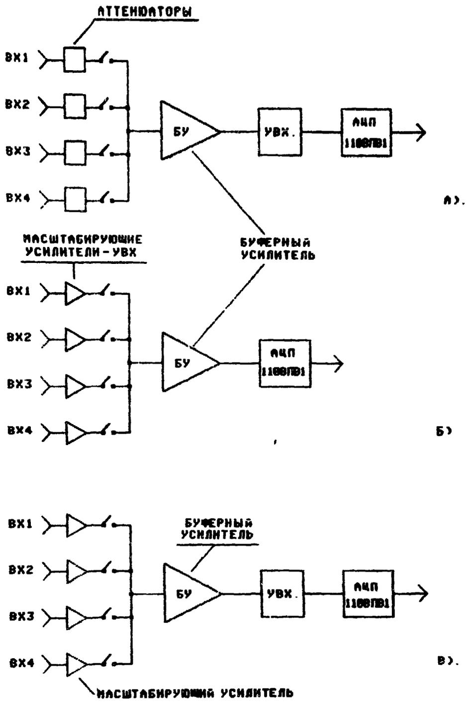
Рис. 1. Возможные варианты структурных схем четырехканального регистратора.
