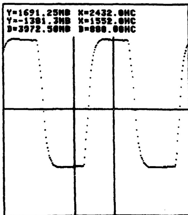
Рис. 4. Вид напряжения на выходе коммутирующего узла при переключении с канала на канал. Положение левого курсора соответствует моменту поступления команды на переключение, положение правого -- времени установления с ошибкой  $0.5 \cdot 10^{-3}$ .
