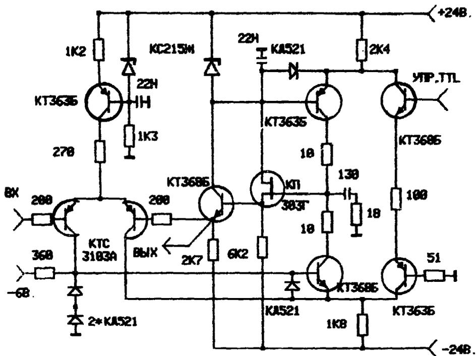
Рис. 6. Схема устройства выборки — хранения.
