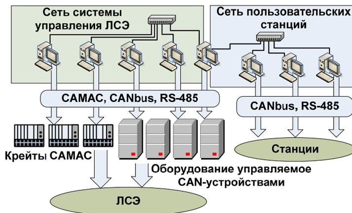
Рис. 3. Схема системы управления ЛСЭ
