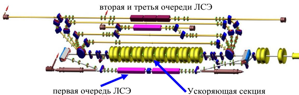
Рис. 1. Схема многооборотного ускорителя-рекуператора Новосибирского ЛСЭ
