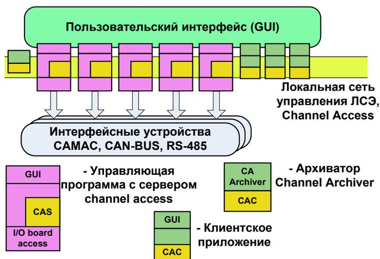
Рис. 4. Архитектура управляющего программного обеспечения
