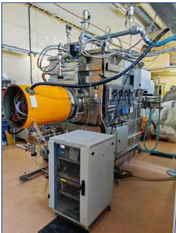
Инжектор мощных атомарных пучков, разработанный и произведенный в ИЯФе. Фото П. Дейчули.
