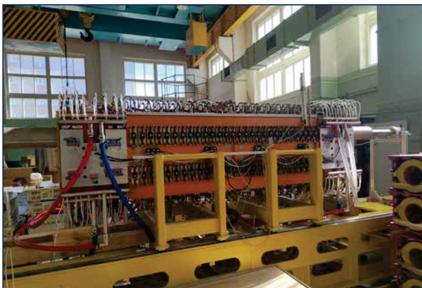
Соленоид для системы электронного охлаждения (СЭО) коллайдера NICA.
