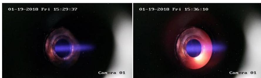
Рисунок 5 – Прохождение пучка отрицательных ионов водорода без нагрева входной диафрагмы (слева) и нагрев входной диафрагмы при повышении тока пучка (справа). Пучок ионов виден синим, нагрев диафрагмы – красным
