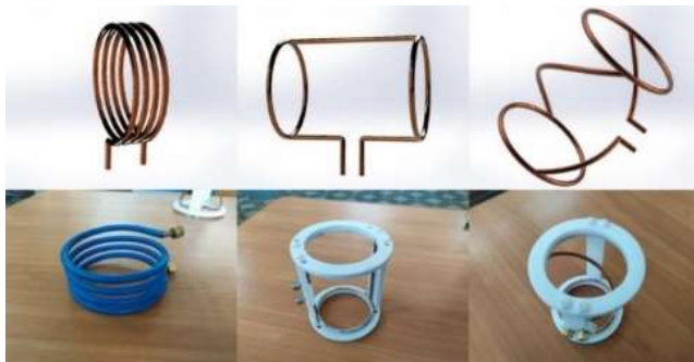
Рисунок 2 — Типы использованных ВЧ антенн: витковая ( d_a=3.6 см, m=0 ); НН ( d_a=16 см, m=\pm 1 ); Н-Н ( d_a=15 см, m=\pm 1 ); диаметр медной трубки d=6 мм
