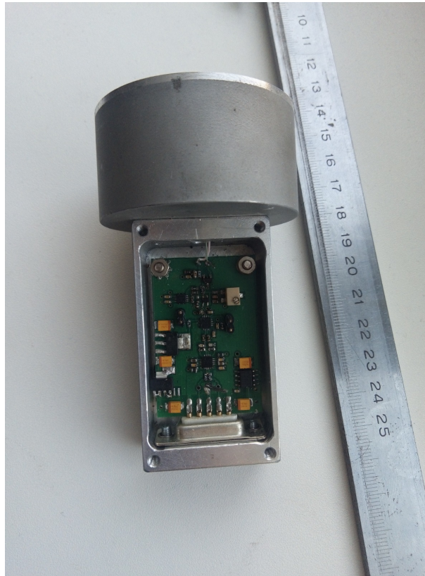
Рисунок 3.16 — Фотография детектора 3 МэВ протонов, подготовленного для установки на ГДЛ
