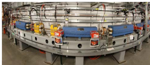
Рис. 5.3.1. Третья арка собранного кольца бустера.
