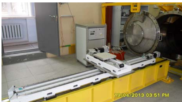
Рис. 5.6.2. Двухкоординатный механизм перемещения свариваемой детали.
