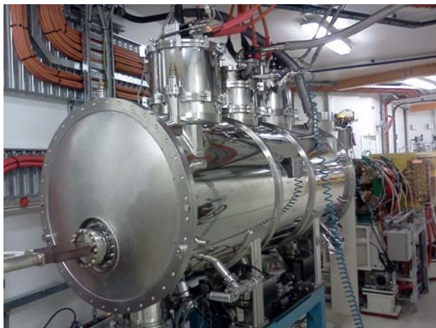
Рис. 6.5.1. 63-полюсный вигглер с полем 4,2 Тл и периодом 52 мм установлен на накопителе Australian Synchrotron (AS) в Мельбурне для биомедицинских исследований.
