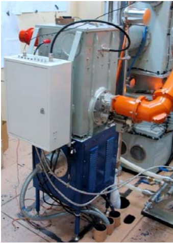
Рис. 7.15.1. Слева – транзисторный предусилитель и предвыходной каскад на ГУ-92А, справа – выходной каскад на ГУ-101А.
