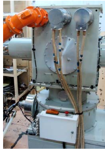
Рис. 7.15.1. Слева – транзисторный предусилитель и предвыходной каскад на ГУ-92А, справа – выходной каскад на ГУ-101А.
