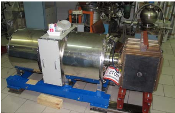
Рис. 7.10.1. Резонатор с присоединенным магнито-разрядным насосом.
