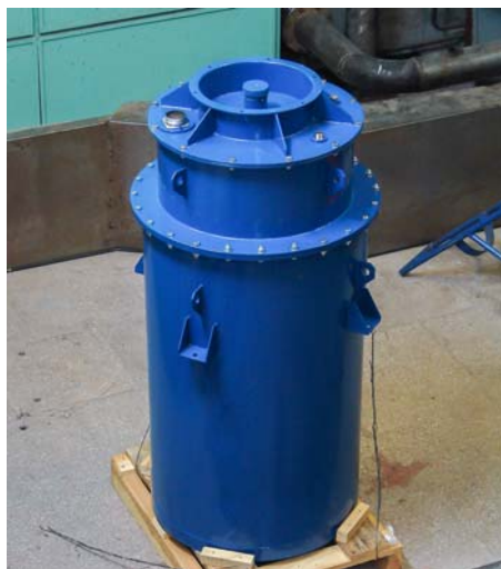
Рис. 6.4.4. Новый высоковольтный выпрямитель для электростатической электронной пушки.
