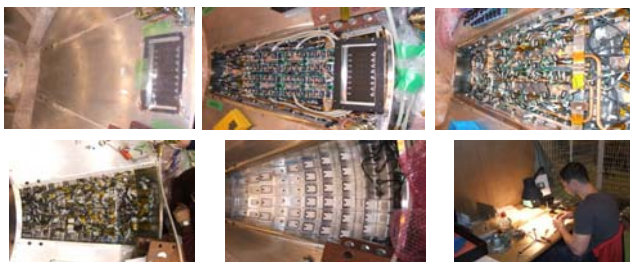
Рис. 1.9.14. Этапы разборки сектора калориметра и замены резисторов.
