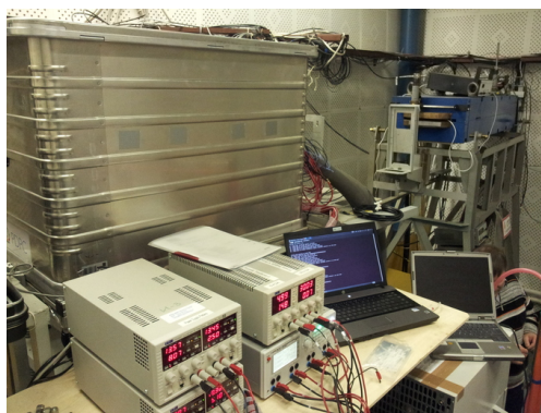
Рис. 1.3.3. Фотография прототипа ФАРИЧ с DPC, установленного на выведенный электронный пучок.
