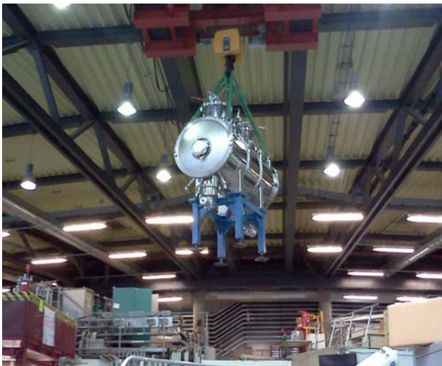
Рис. 6.5.4. Транспортировка модернизированного вигглера с полем 7 Тл НМІ (НВZ) на накопитель BESSY-II.
