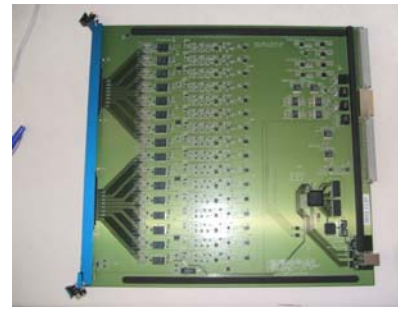
Рис. 1.9.10. Внешний вид модуля формирователя-оцифровщика для торцевого калориметра.
