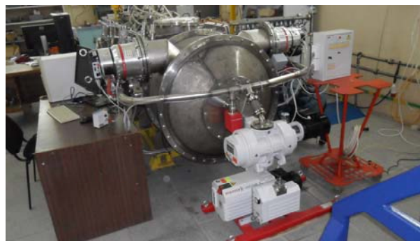
Рис. 5.6.3. Система вакуумной откачки «Установки электронно-лучевой сварки».
