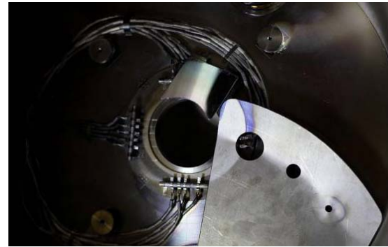
Рис. 9.1.6. Отпечаток аргонового пучка на поворотной диафрагме, расположенной на входе ионного пучка в ускоритель.
