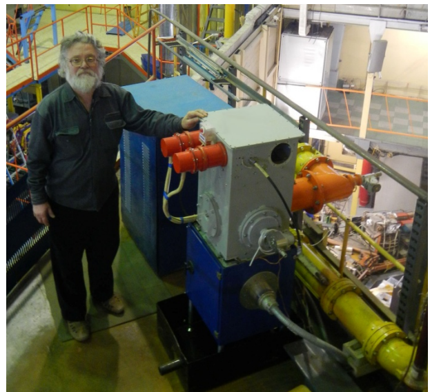
Рис. 7.5.2. Выходной каскад ВЧ генератора БЭП.
