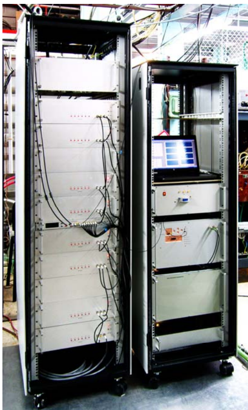
Рис. 7.3.1 Полупроводниковый ВЧ - генератор драйвера атомарного инжектора.
