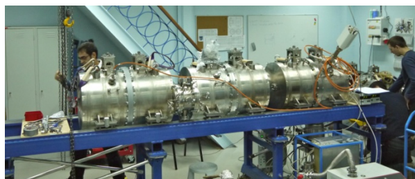
Рис. 7.9.3. Ускоряющий модуль CCDTL в процессе вакуумных испытаний в ИЯФ СО РАН.
