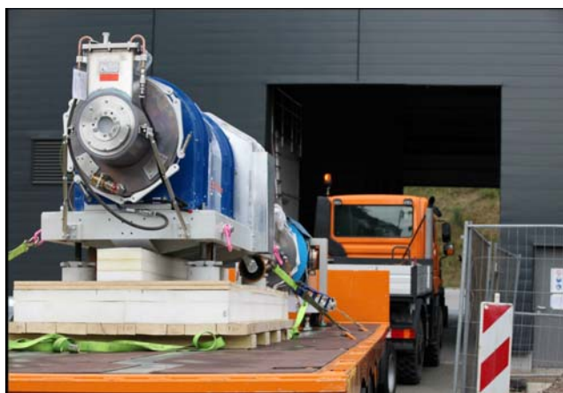
Рис. 5.7.3. Транспортировка первых СВЧ станций в здание инжектора XFEL.
