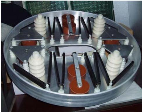
Рис.7.2.2 Секция каскадного генератора – умножителя напряжения.
