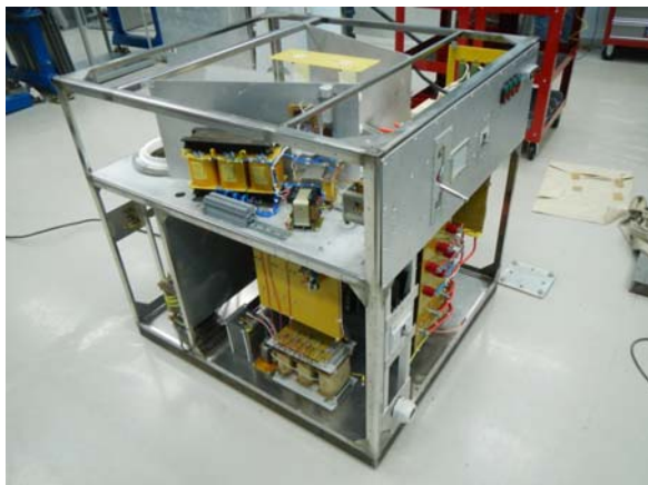
Рис. 7.10.1. ВЧ усилитель мощности в процессе монтажа.
