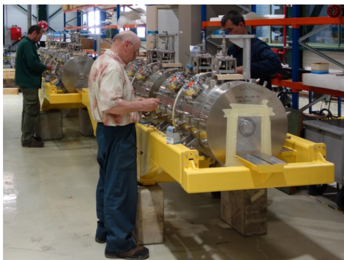
Рис. 7.9.4. Слева – подготовка модулей CCDTL №5 и №6 к испытаниям в CERN. Справа – модуль №2 в защищенном бункере в процессе «горячих» испытаний.
