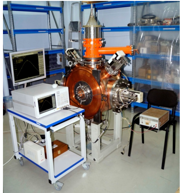
Рис. 7.5.1. ВЧ измерения параметров нового резонатора БЭП.
