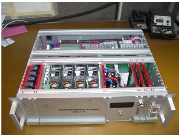
Рис. 7.1.3. Прецизионный источник тока корректирующих магнитов.
