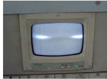
Рис. 5.2.6. Изображение электронного сгустка с энергией 1,85 ГэВ на мониторе СИ при амплитуде напряжения на пластинах ВЧ разведения около 6,5 кВ. Радиальная бетатронная частота Q_x=0,53 . Между положениями орбиты сгустка около 7 мм (на азимуте монитора \beta_x=1200 см). Монитор работает в непрерывном режиме, поэтому орбита, замыкающаяся через два оборота, представлена двумя изображениями одного и того же сгустка.
