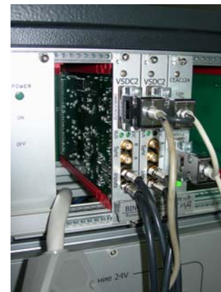
Рис.7.17.9. Управляющие и измерительные модули источника ГИД-25.
