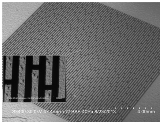
Рис. 6.2.11. Изготовленная с помощью МПРЛ микрорешетка из резиста SU-8 на стеклоуглеродной подложке с гальванически осажденным золотым покрытием толщиной около 50 мкм. Период структуры 130 мкм, ширина линий 65 мкм, общее поле решетки 1 × 1 см 2 .
