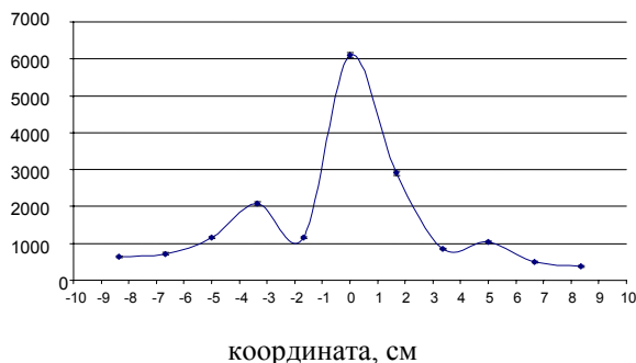
Рис. 9.1.3. Пространственное распределение интенсивности нейтронного потока под мишенью по активации индия.
