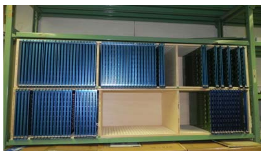
Рис. 1.9.8. Изготовленные модули формирователей-оцифровщиков в стеллаже.
