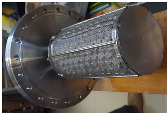
Рис. 5.11.1 Прототип картриджа на основе таблеток из TiZrAl.
