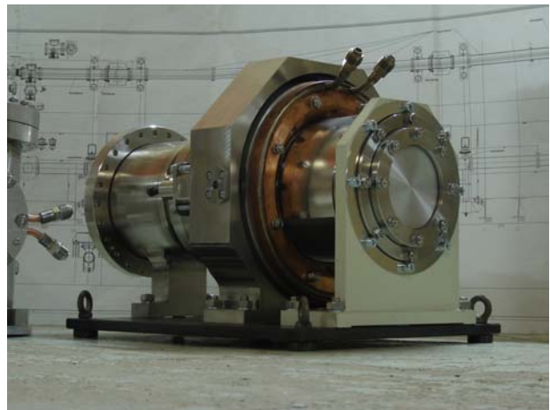
Рис. 6.4.2. Узел зеркала оптического резонатора третьей очереди ЛСЭ.
