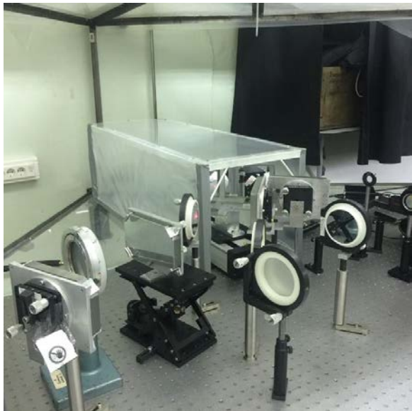
Рис. 6.4.5. Линия задержки с продувкой азотом. Видно также, что вся система помещена в «шатер», продуваемый сухим воздухом.
