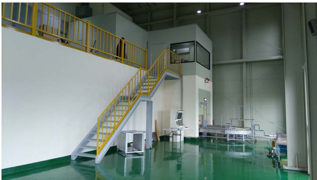
Рис. 8.1.1. Зона загрузки конвейера и пультовая (на втором этаже) Биомедицинского производственно-технологического центра компании КИТЕС с ускорителя ИЛУ-10 в городе Йончон, Республика Корея.
