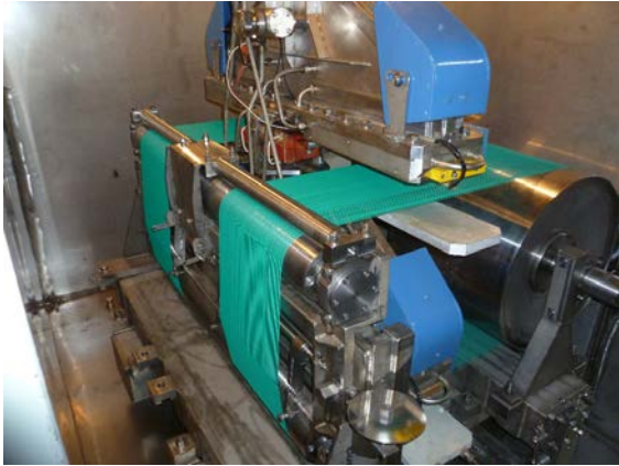
Рис. 8.1.3. Новое перематывающее устройство под выпускным окном ускорителя ИЛУ-8 в компании “Гамма сервис”, г. Ивантеевка.
