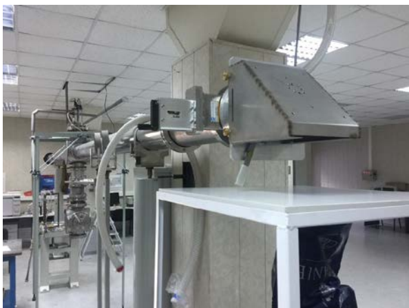
Рис. 6.4.6. Вывод транспортного канала к рабочей станции для исследования динамики релаксации процессов в конденсированных средах
