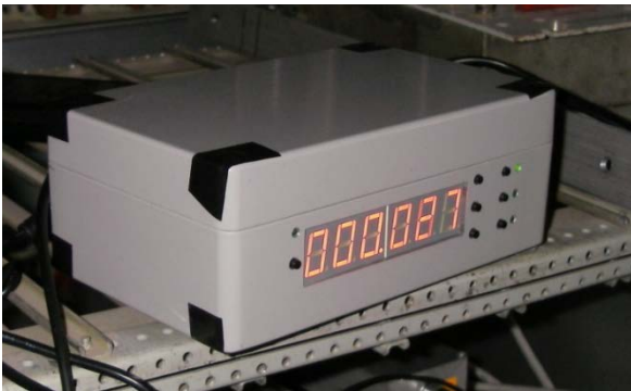
Рис.6.2.6. Источник высокого напряжения стенда проверки сцинтилляционных кристаллов.
