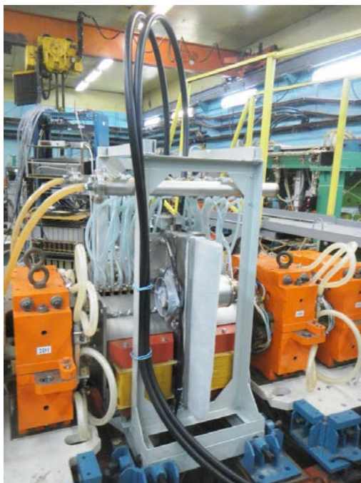
Рис. 7.3.3 Резонатор (слева) и усилитель (справа на переднем плане) новой ВЧ системы накопителя-охладителя.
