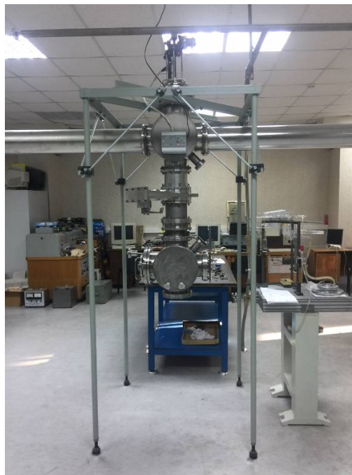
Рис. 6.4.4. Фотография транспортного канала с устройством, обеспечивающим оперативное разветвление пучка НЛСЭ на четыре направления.
