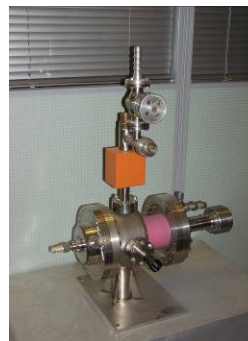
Рис. 5.5.11. Электронная пушка с напряжением до 50 кВ.
