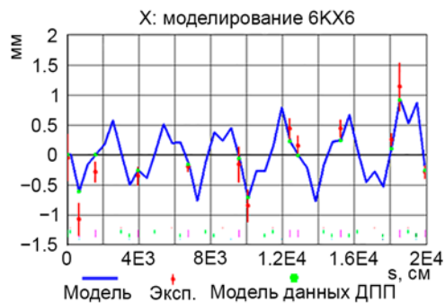
Рис. 5.1.12. Подгонка модельных откликов под измеренные для корректора 6КХ6.
