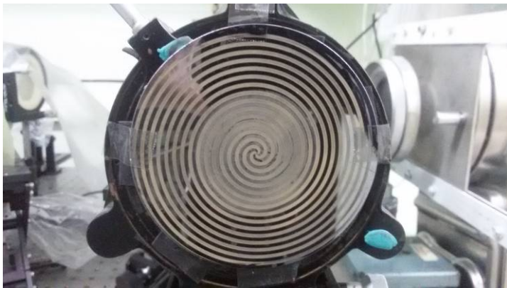
Рис. 6.4.16. Бинарный спиральный аксикон третьего порядка и сечение сформированного им пучка при длине волны 130 мкм на расстоянии 300 мм от аксикона.
