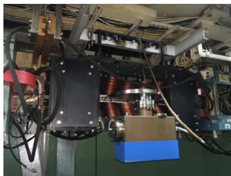
Рис. 5.9.14: Вакуумная камера и вигглер NIW на накопителе ВЭПП-4М.
