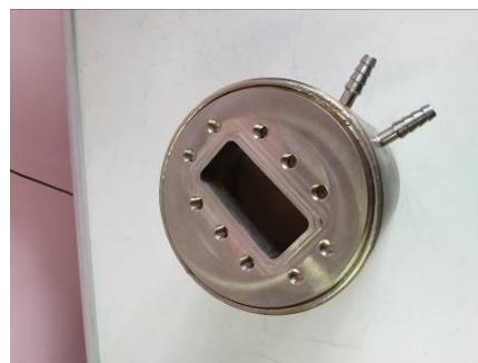
Рис. 5.5.3. Элементы выходного волноводного тракта клистрона: сверху волноводный делитель-сумматор с вакуумными окнами баночного типа, внизу – вакуумное волноводное окно на бегущей волне.
