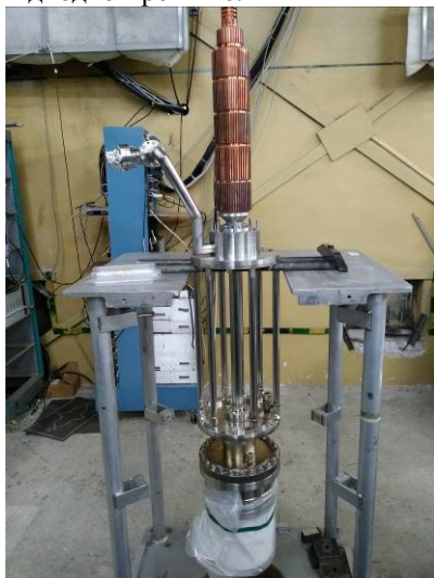
Рис. 5.5.1. Макет клистрона для испытания в диодном режиме.
