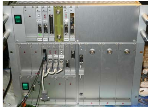
Рис.7.1.8. Комплект доработанных электронных блоков 60-МэВ кулера перед отправкой в Дубну.
