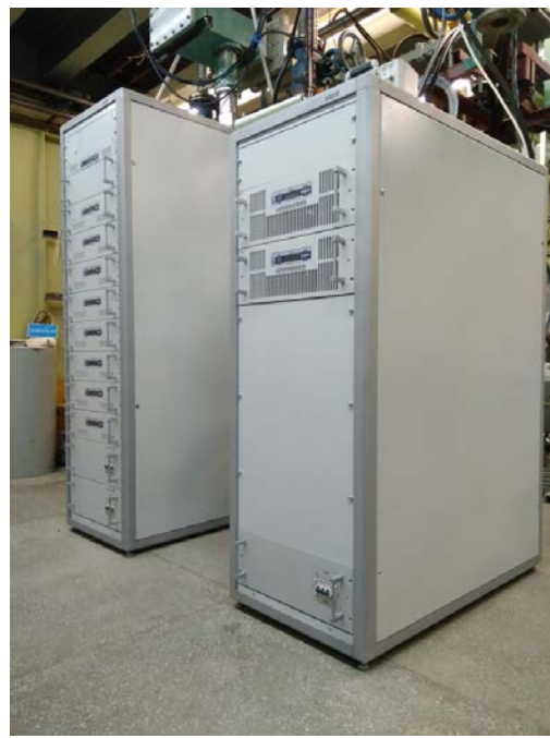
Рис. 7.3.3 Резонатор (слева) и усилитель (справа на переднем плане) новой ВЧ системы накопителя-охладителя.
