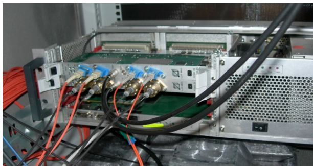
Рис.7.1.3. VME модули ADC4X 250 APD с оптическим входом для определения места и величины потерь пучка в ускорительном тракте.
