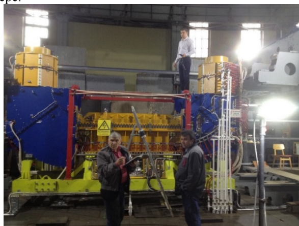
Рис. 5.3.1: Сборка СЭО бустера НИКА в ОИЯИ (г. Дубна).
