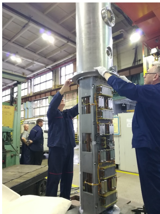
Рис. 6.5.3. Процесс установки сверхпроводящей магнитной системы 22-полюсного вигглера с полем 7 Тл и периодом 127 мм для накопителя DELTA (Дортмунд, Германия) в гелиевый сосуд криостата.
