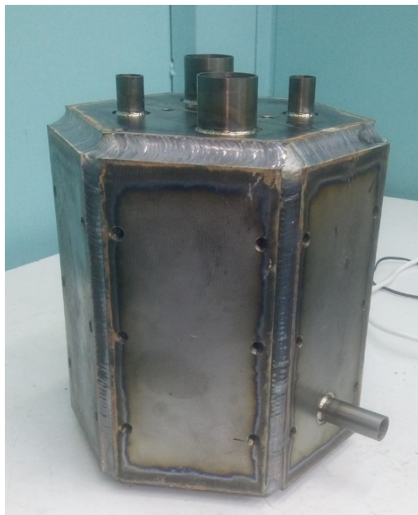
Рис. 8.2.5. Корпус макета реактора после сварки.
