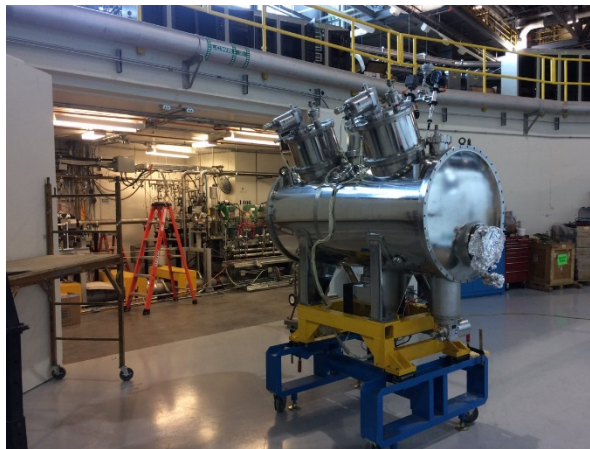
Рис. 6.5.1. 63-полюсный вигглер для CLS (Саскатун, Канада) с полем 2 Тл и периодом 34 мм во время модернизации криогенной системы.
