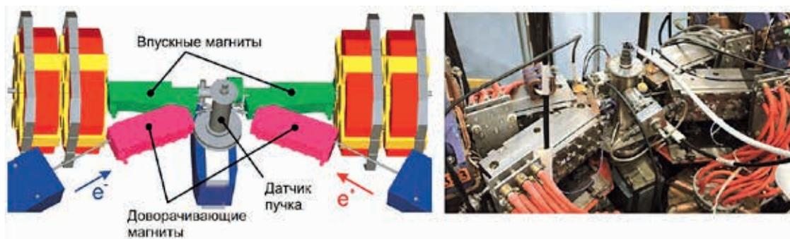
**Рис. 12.** Участок инжекции в 3D-модели (слева) и в реальности (справа)
