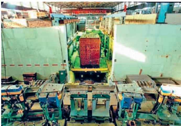
**Рис. 18.** Этап монтажа центральной части экспериментального промежутка и отдельно детектора МД-1
