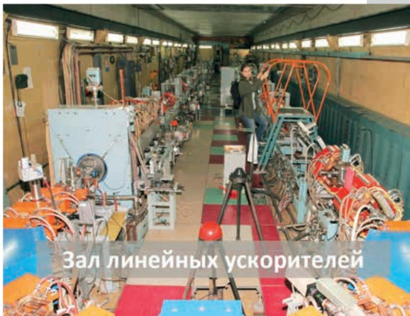
**Рис. 14.** Общий вид зала форинжктора. Справа ускоритель электронов, внизу по центру магнитная система изохронного поворота, слева за поворотом – конверсионная система и основной ускоритель на 510 МэВ
