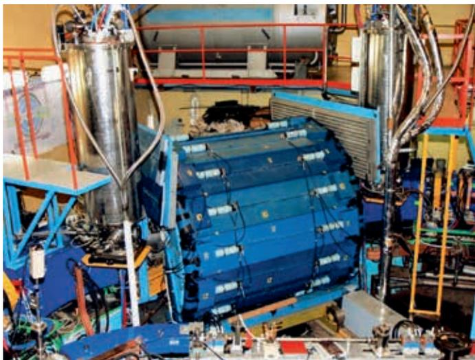
**Рис. 3.** Детектор СНД на ВЭПП-2000. Снаружи видны сцинтилляционные счетчики мюонного детектора
