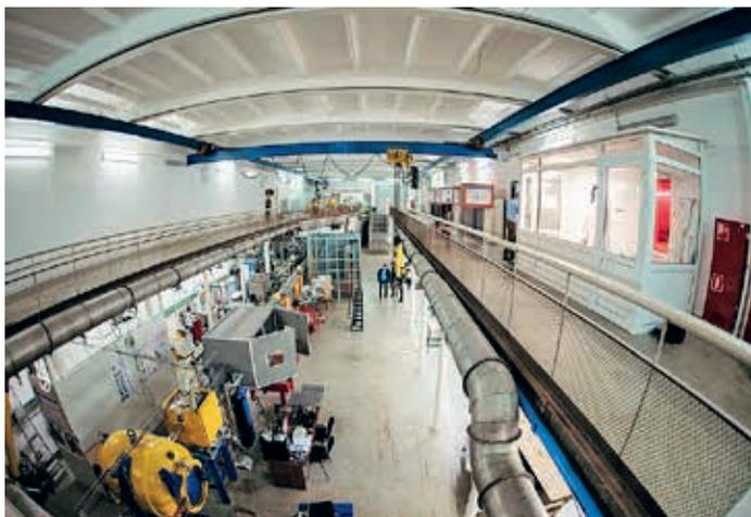
Используются два режима работы: низкоэнергетичный с энергией 1,9 ГэВ и высокоэнергетичный с энергией свыше 4 ГэВ. Максимальный ток до 20 мА. Используются одногустковый и многугустковый режимы и общим током до 20 мА.
