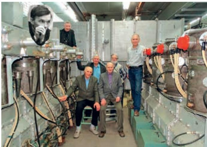
В связи с переходом к 2-сгустковому режиму на ВЭПП-4М потребовался перевод бустера ВЭПП-3 также в 2-сгустковый режим. Для этого была переделана высокочастотная система 1-й гармоники на 2-ю, а 19-й гармоники на 18-ю [9].
