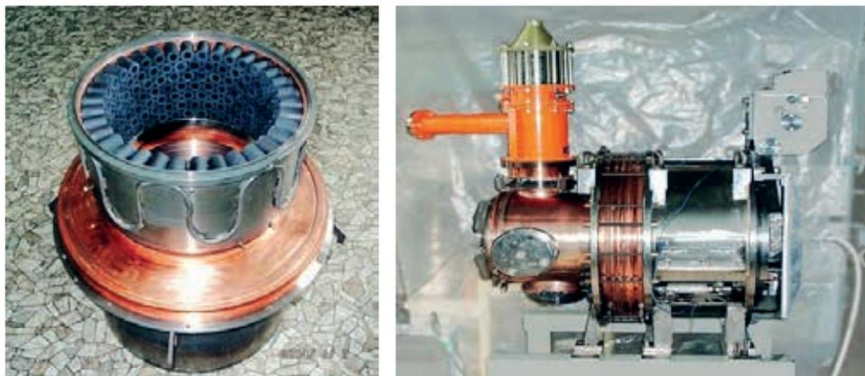
**Рис. 14.** Слева: слой керамических элементов коаксиальной нагрузки для поглощения высших мод. Справа: резонатор на измерительном стенде
