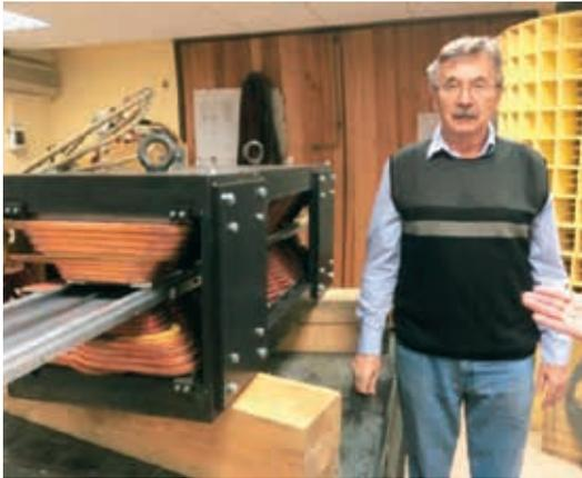
**Рис. 36.** 9-полюсный вигглер и его создатель П.Д. Воблый
