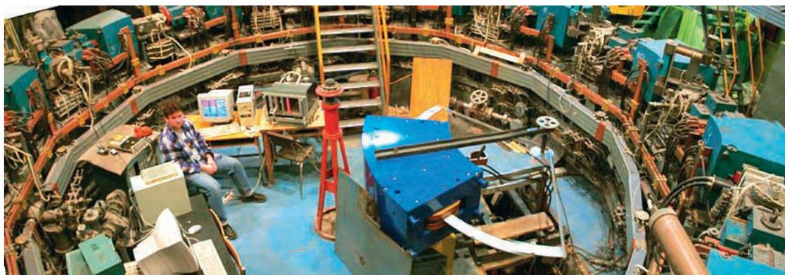
**Рис. 7.** П.Ю. Шатунов проводит магнитные измерения диполя ВЭПП-2000. 2002 год
