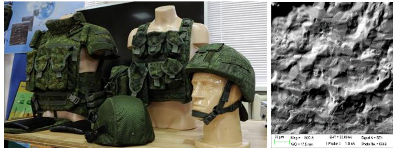
Бронежилеты и защитные шлемы из керамики на основе карбида бора (справа) и микроструктура спекаемых изделий (слева).
