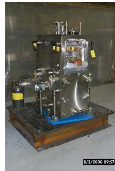
5.5Т супербэнд, изготовленный в Беркли для ALS
