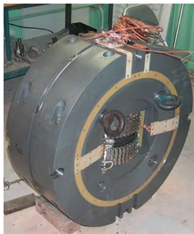
9.3 Т супербэнд для BESSY, изготовленный в ИЯФ
