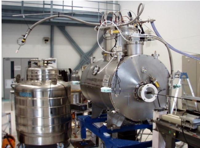
10 Т сверхпроводящий шифтер на магнитных измерениях
