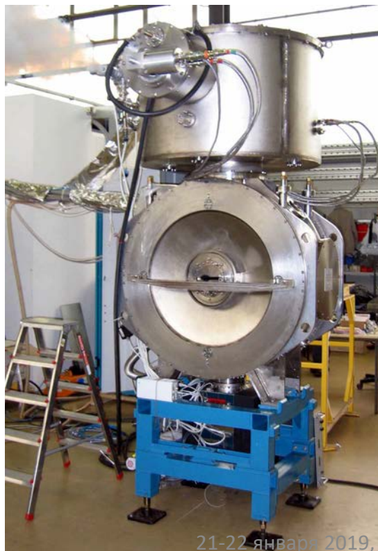
5.5Т супербэнд, изготовленный в Беркли для ALS
