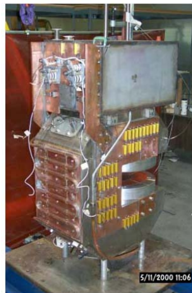
5.5Т супербэнд, изготовленный в Беркли для ALS
