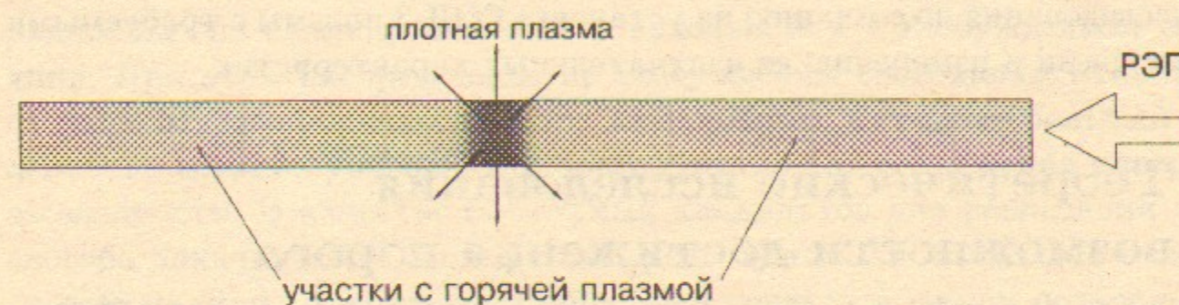
Рис. 1. Схема интенсивного источника УФ излучения на установке ГОЛ-3.
