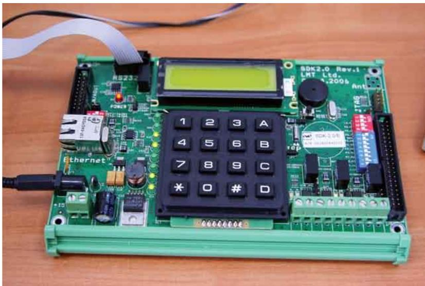
» Учебный стенд SDK-2.0 на базе ARM7TDMI (Philips LPC2292), производство ЛМТ.
