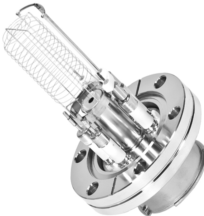
Рис.1. Лампа Баярда-Альперта, катод: иридий с окисью тора, заводской сборки.
