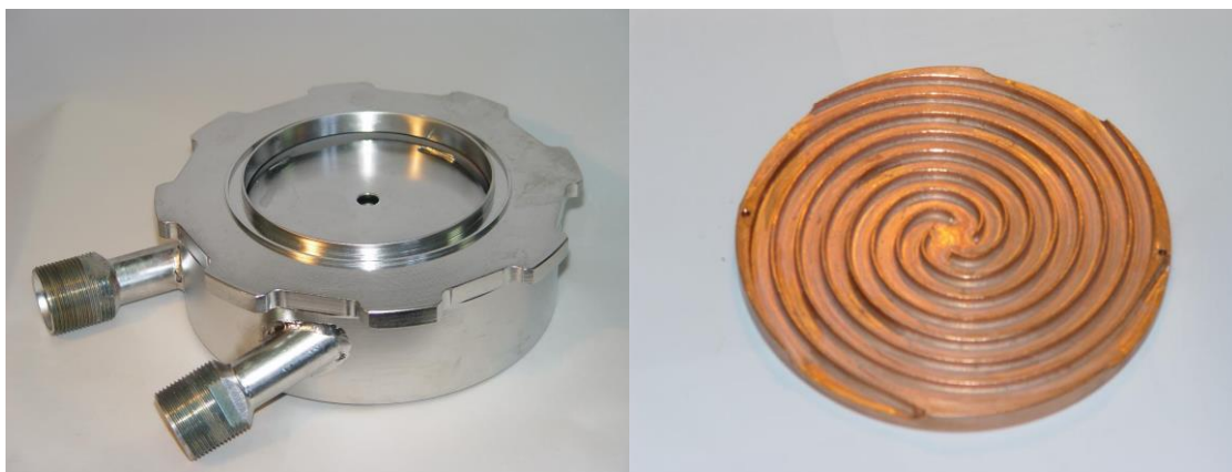
Рис. 3. Фотографии собранной мишени без приемника пучка (слева) и медного диска со стороны, охлаждаемой водой (справа).
