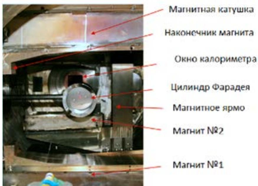
Рисунок 8. ЦФ в вакуумном баке
