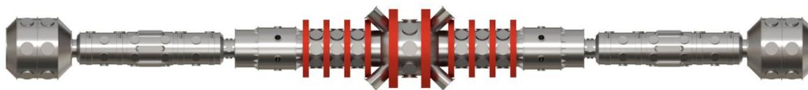
Проект установки ГДМЛ с секциями многопробочного удержания (длина 24 метра)
