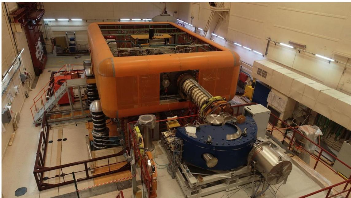
Стенд для испытаний инжектора пучка атомов водорода с энергией до 1 МэВ
