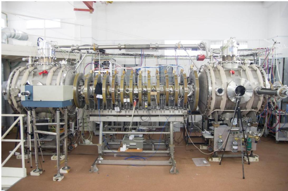
Установка СМОЛА для изучения течения плазмы в винтовом магнитном поле
