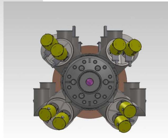
Прототипы инжекторов (40 кэВ, 40 А, 1с) разработаны для проекта ТАС
