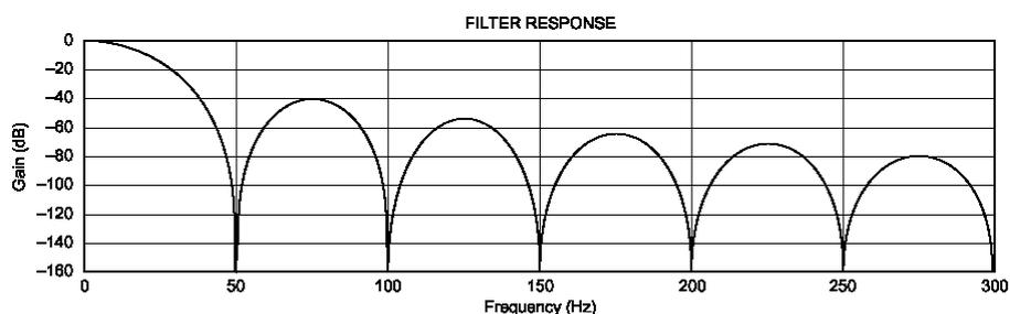
По этой причине не рекомендуется устанавливать время измерения менее 20 мсек. Однако, если трассы между измерителем и источником измеряемого сигнала выполнены качественно, то возможно проводить измерения и на более коротких временах.
