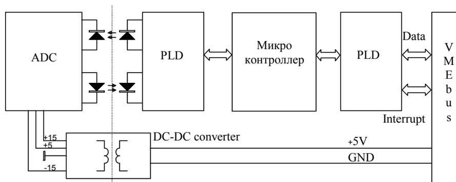
Рис.1. Структурная схема аналого-цифрового преобразователя.
