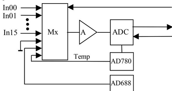
Рис.2. Блок-схема аналоговой части преобразователя.
