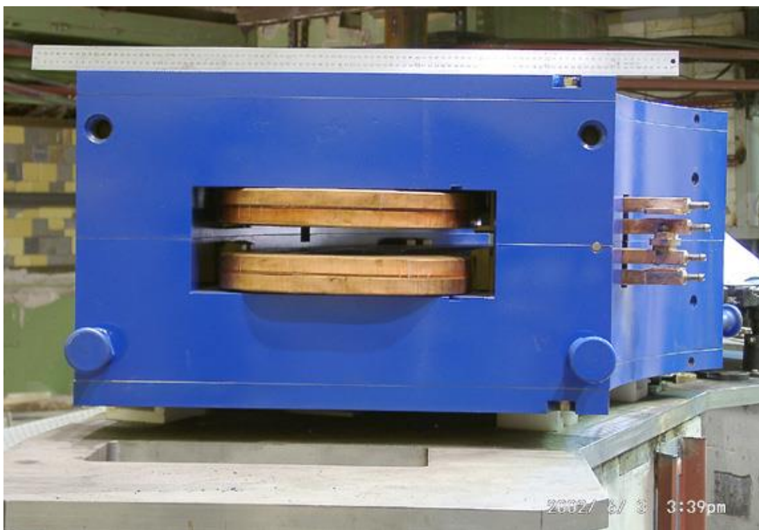
Рис.5 Дипольный магнит ВЭПП-2000 в сборе.
