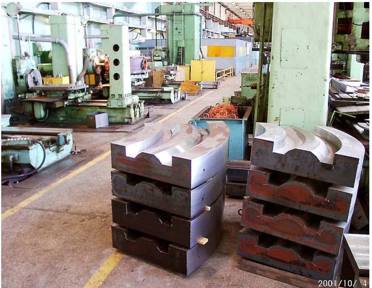
Рис.4 Магнитопроводы дипольных магнитов ВЭП-2000 в экспериментальном
