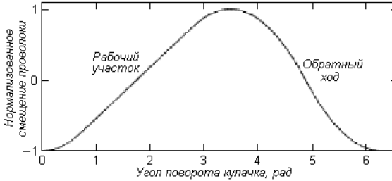
Рис. 2.15. Зависимость положения электрода от угла поворота кулачка
