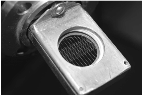
Рис. 2.9. Фотография сеточного вторично-эмиссионного датчика
